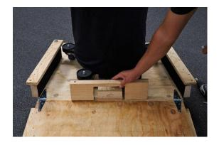
7. WITH 2 PEOPLE AND THE RAMP IN PLACE, UNLOCK THE BRAKES ON THE CASTER WHEELS BY TURNING THEM TO THE "OFF" POSITION. CAREFULLY ROLL THE SPEAKER OFF OF THE FOAM, DOWN THE RAMP THAT HAS BEEN CREATED WITH THE DOOR OF THE CRATE AND CLOSE TO THE FINAL LISTENING POSITION. REMEMBER ONLY TO PUSH FROM THE FRONT OR THE SIDE OF THE CABINET. NEVER PUSH FROM THE REAR YOU WILL RISK PUSHING OVER THE SPEAKER.
